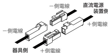
器具側のコネクターと直流電源装置側のコネクターが相互に合うようにしっかりと差し込んでください。差し込みが不十分な場合、接触不良により**火災の原因**となります。
