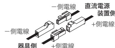
器具側のコネクターと直流電源装置側のコネクターが相互に合うようにしっかりと差し込んでください。差し込みが不十分な場合接触不良により、火災の原因となります。
