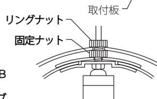
2.プレートBをかぶせ固定ナットを締め付け固定する。カバーをかぶせリングナットを締め付け固定する。
