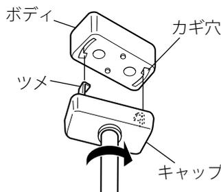
カギ穴の中が広がっている部分にツメを合わせて差し込み時計方向にカチッと音がするまで回して固定する。
