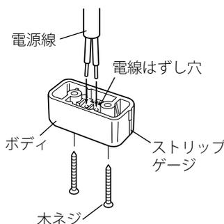
電源線の外部被覆をストリップゲージに合わせて取り、確実に差し込む。
