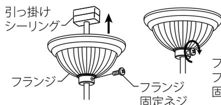
フランジを引き上げ、フランジ固定ネジで固定してください。
