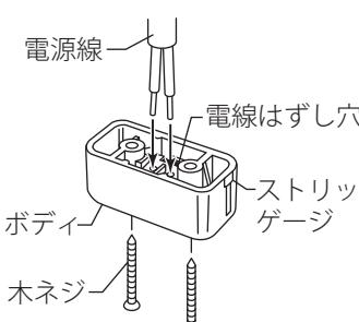
電源線の外部被覆をストリップゲージに合わせて取り、確実に差し込んでください。
