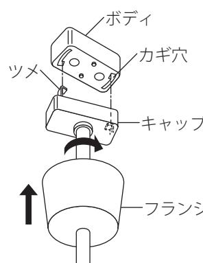
カギ穴の巾が広くなっている部分にツメを合わせて差し込み時計方向にカチッと音がするまで回して固定する。
