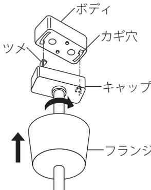
カギ穴の中が広がっている部分にツメを合わせて差し込み時計方向にカチッと音がするまで回して固定する。
