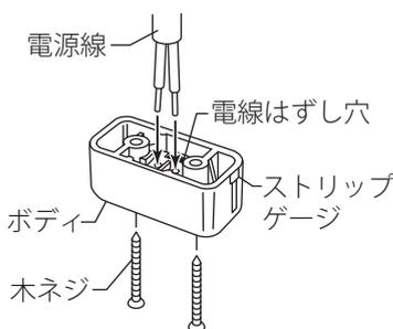
電源線の外部被覆をストリップゲージに合わせて取り、確実に差し込んでください。
