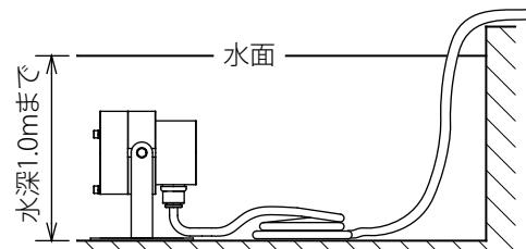
※灯具を水中から引き上げて保守・点検ができる様、ケーブルに灯具の設置水深+1m程度の余裕を持たせて設置してください。
