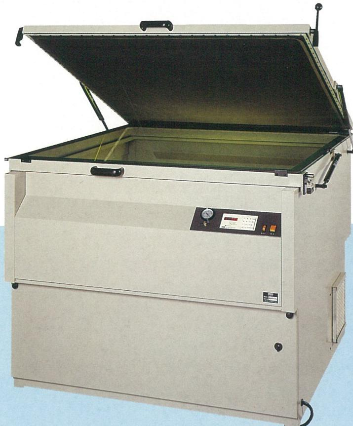
UP-S真空焼付機はスクリーン刷版作業に必要な機能と操作性を重視したスクリーン版専用焼付機です。ウシオ電機製「ユニレック3KW」光源を搭載、高照度分布のもとでの露光時間の短縮が可能になります。スクリーン版をセットし焼枠をロックしますと露光終了までフルオートで使用できます。品質管理に大切な露光制御方法には作業内容に合せて積算光量計、データメモリー、照度計機能など豊富な選択ができます。
