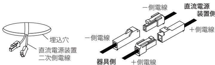
器具側のコネクターと直流電源装置側のコネクターが相互に合うようにしっかりと差し込んでください。差し込みが不十分な場合、接触不良により**火災の原因**となります。
