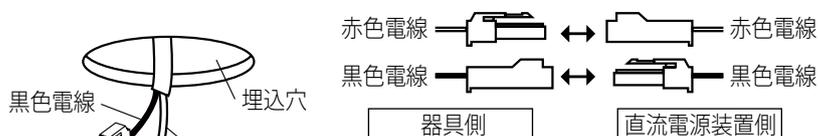
器具側のコネクターと直流電源装置側のコネクターが相互に合うようにしっかりと差し込んでください。差し込みが不十分な場合接触不良により、**火災の原因**となります。
