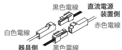
器具側のコネクターと直流電源装置側のコネクターが相互に合うようにしっかりと差し込んでください。差し込みが不十分な場合接触不良により、**火災の原因**となります。
