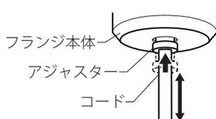
アジャスターをフランジ本体方向へ押し上げコード長を調整してください。調整後はアジャスターを引き下げ、確実にコードを固定してください。
