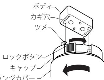
フランジカバーを反時計方向に回して取外し、カギ穴の中が広がっている部分にツメを合わせて差し込み時計方向にカチッと音がするまで回して固定する。
