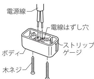
電源線の外部被覆をストリップゲージに合わせて取り、確実に差し込む。
