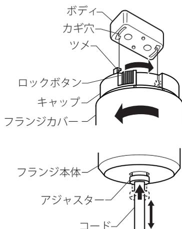
フランジカバーを反時計方向に回して取外し、カギ穴の中が広がっている部分にツメを合わせて差し込み時計方向にカチッと音がするまで回して固定する。
