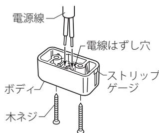
電源線の外部被覆をストリップゲージに合わせて取り、確実に差し込む。
