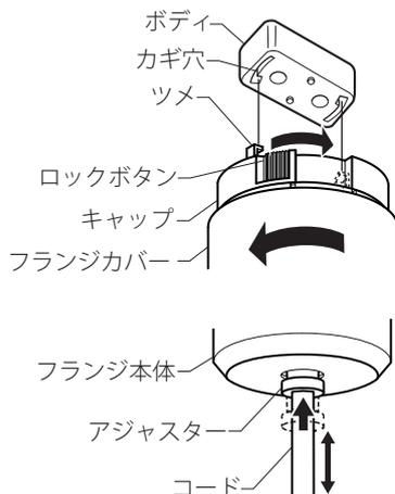
フランジカバーを反時計方向に回して取外し、カギ穴の中が広がっている部分にツメを合わせて差し込み時計方向にカチッと音がするまで回して固定する。
