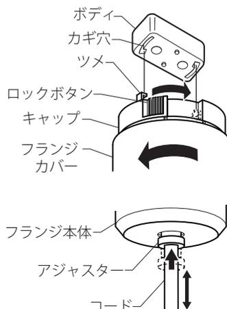
フランジカバーを反時計方向に回して取外し、カギ穴の中が広がっている部分にツメを合わせて差し込み時計方向にカチッと音がするまで回して固定する。
