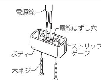
電源線の外部被覆をストリップゲージに合わせて取り、確実に差し込む。
