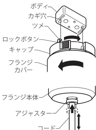
フランジカバーを反時計方向に回して取外し、カギ穴の中が広がっている部分にツメを合わせて差し込み時計方向にカチツと音がするまで回して固定する。
