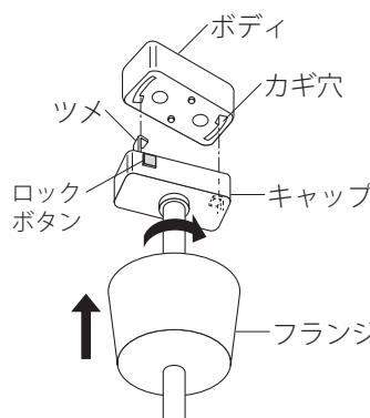
カギ穴の巾が広くなっている部分にツメを合わせて差し込み時計方向にカチッと音がするまで回して固定する。
