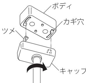
カギ穴の中が広がっている部分にツメを合わせて差し込み、時計方向にカチッと音がするまで回して取付けてください。
