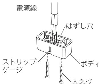
電源線の外部被覆をストリップゲージに合わせてむき、確実に差し込んでください。
