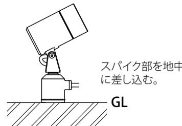
器具が横倒しの状態やGLラインを超えて水没した状態で放置された場合、浸水や結露により、**感電や絶縁不良の原因**となりますので、ご注意ください。
